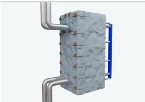
Съемные теплоизоляционные энергетические чехлы марки «Корда-ЧСТЭ» – это мягкий кожух из минеральной ваты (либо других утеплителей, подобранных исходя из температуры эксплуатации), закрытый со всех сторон обкладочным материалом. Изделия предназначены для многократного применения в качестве теплоизоляции **теплообменников** (пластинчатых, кожухотрубных).
